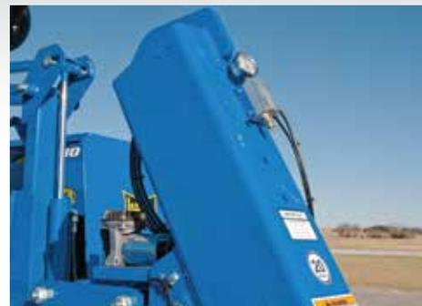
**Воздушный компрессор и манометр**
